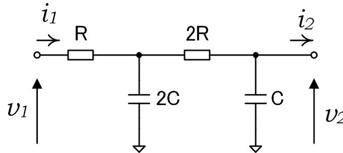
$$\begin{bmatrix} 1 & R \\ 0 & 1 \end{bmatrix} \begin{bmatrix} 1 & 0 \\ j\omega 2C & 1 \end{bmatrix} \begin{bmatrix} 1 & 2R \\ 0 & 1 \end{bmatrix} \begin{bmatrix} 1 & 0 \\ j\omega C & 1 \end{bmatrix} = \begin{bmatrix} 1 + j\omega 2CR & R \\ j\omega 2C & 1 \end{bmatrix} \begin{bmatrix} 1 + j\omega 2CR & 2R \\ j\omega C & 1 \end{bmatrix} =$$
