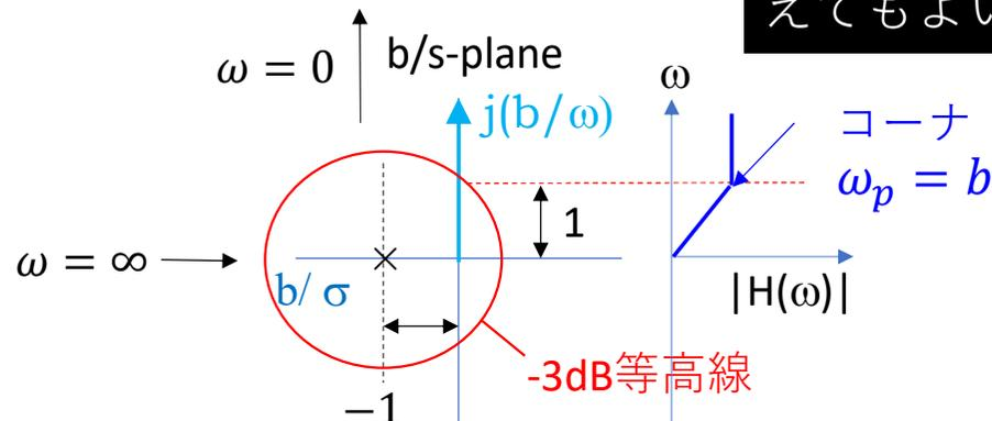
**[NOTE]** 軸を $\omega_p$ で規格化して逆数にするとLPF特性がHPF特性に変換される。
