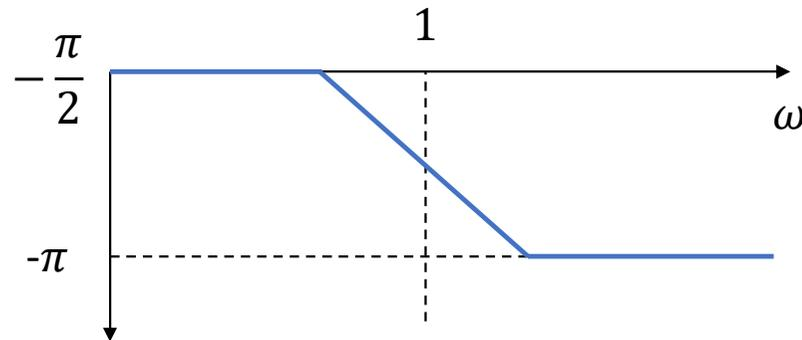
1. 素直に解けば上記のようになるが、 $\omega = 0$ で位相が $-\pi/2$ というのは奇異に感じるかもしれない（直流の位相？）。 $\omega = 0$ の位相は、直流の位相ではなく、 $\omega \rightarrow 0$ のときの漸近値を表している。
