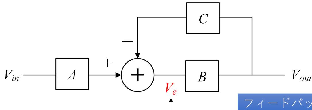
フィードバックがある場合は、加算器の後ろに変数を置いて式を立てる。
