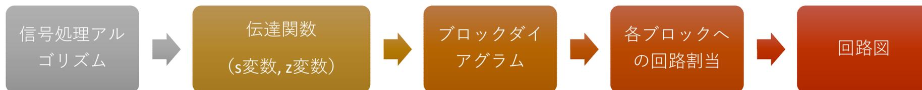
ただし、アナログ回路は、非線形演算を高精度に行うことが難しいため、実現しやすい線形演算（積分、微分、定数倍、加減算）と必要ならコンパレータ（大小比較）、乗算のブロックを組み合わせたブロック線図で処理手順を表現する。
