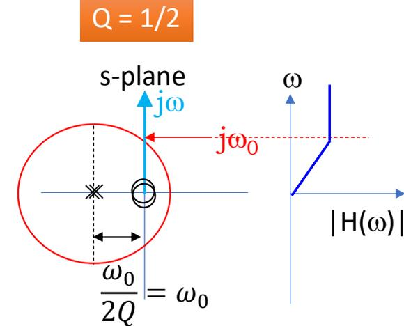
Q2.  $R^2C^2 = 4LC$ のとき、周波数伝達関数の振幅特性のボード線図を示せ。
