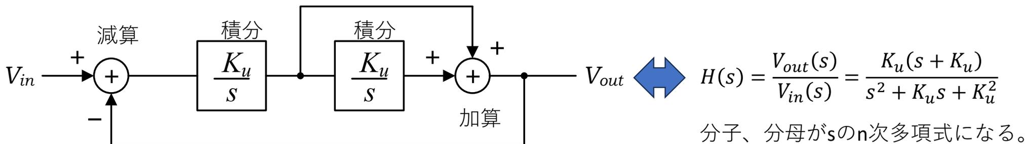
Q1.1 伝達関数  $H = V_{out}/V_{in}$  を求めよ。
